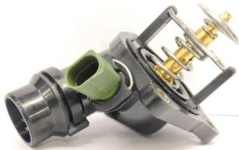
Para evitar el sobrecalentamiento del motor, por ejemplo, cuando se conduce cuesta arriba, la ECU activa el termostato MAP antes de que la temperatura del sistema de enfriamiento sea crítica. Al calentar la cera, el termostato se abrirá mucho antes de que aumente la temperatura del refrigerante.
